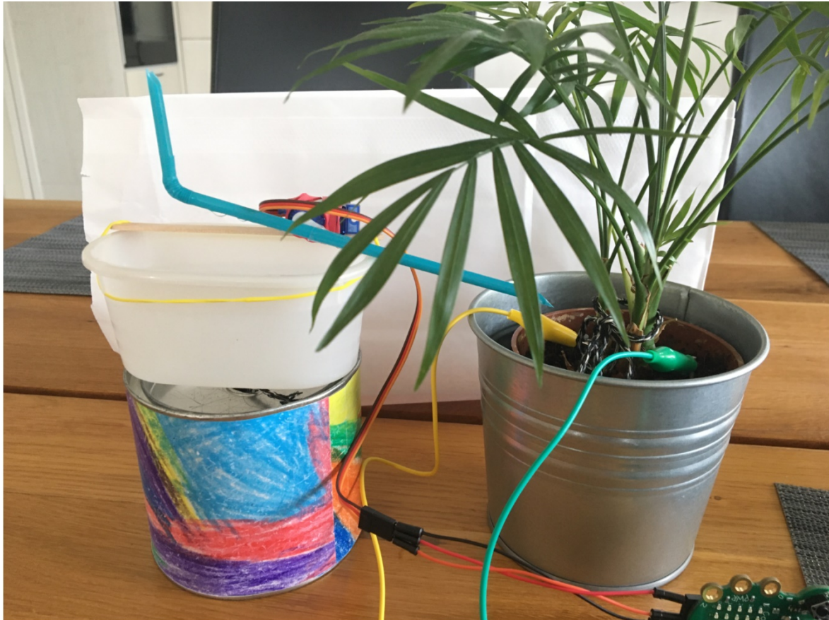
Abbildung 1 Einfaches Pflanztopf Bewässerungssystem mit Servomotor und Mini-Computer
